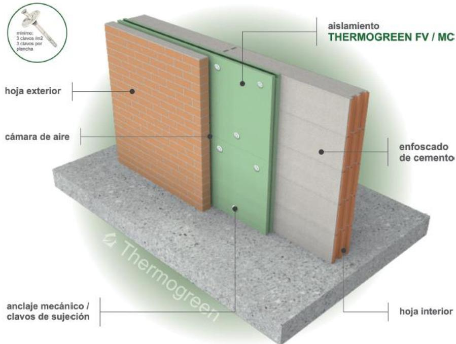
**NOTA:** Mínimo 3 clavos por plancha ( 3 clavos por m<sup>2</sup> )
