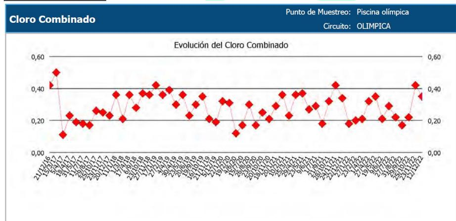
Resultados: Incluso apagando el sistema ultravioleta, se mantiene el cloro combinado en una media de 0,35 ppm.
