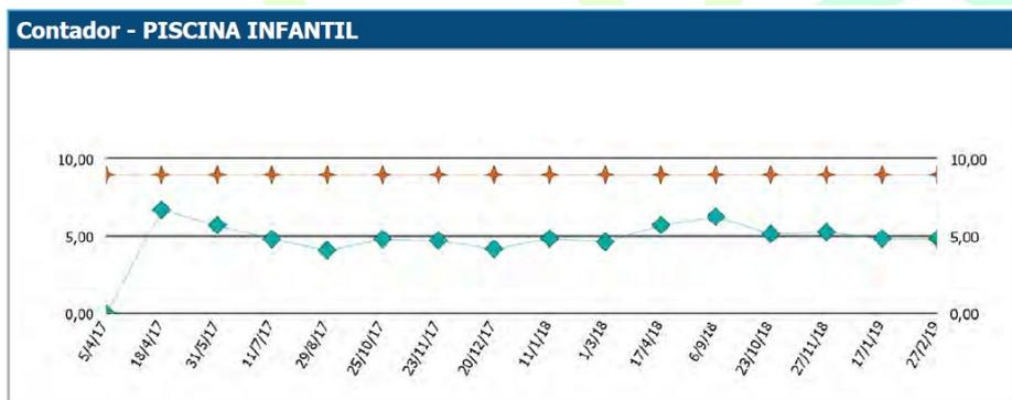
Resultados: A pesar de apagar el sistema ultravioleta desde el inicio del tratamiento, el cloro combinado se mantiene en una media de 0,4 ppm. Respecto al consumo de agua, se alcanzan ahorros superiores al 40%. Por otro lado, con respecto a la conductividad, se asegura el cumplimiento de la normativa al 100% no sobrepasándose el valor de 1000 µS/cm en ningún momento.
