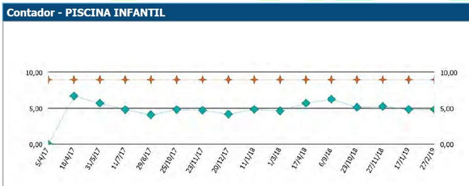
*Resultados: A pesar de apagar el sistema ultravioleta desde el inicio del tratamiento, el cloro combinado se mantiene en una media de 0,4 ppm. Respecto al consumo de agua, se alcanzan ahorros superiores al 40%. Por otro lado, con respecto a la conductividad, se asegura el cumplimiento de la normativa al 100% no sobrepasándose el valor de 1000  $\mu\text{S/cm}$  en ningún momento.*
