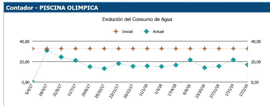
*Resultados: Incluso apagando el sistema ultravioleta, se mantiene el cloro combinado en una media de 0,35 ppm. Respecto al consumo de agua, se alcanzan ahorros superiores al 40%.*
