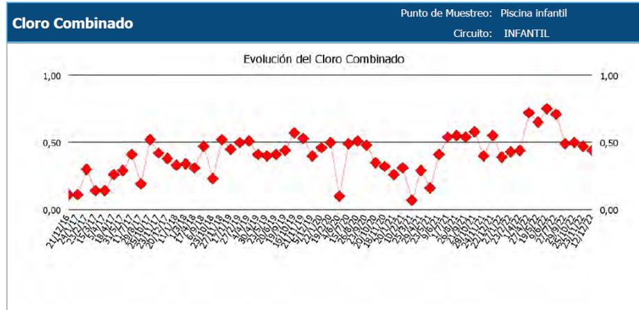
*Resultados: A pesar de apagar el sistema ultravioleta desde el inicio del tratamiento, el cloro combinado se mantiene en una media de 0,4 ppm. Por otro lado, con respecto a la conductividad, se asegura el cumplimiento de la normativa al 100% no sobrepasándose el valor de 1000 µS/cm en ningún momento.*
