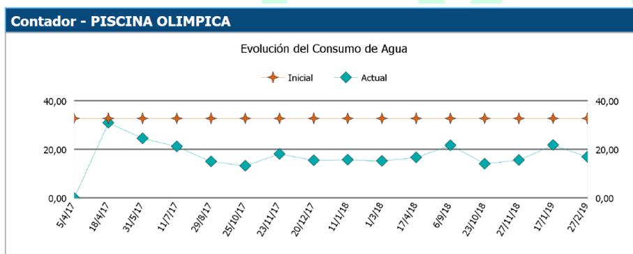
*Resultados: Incluso apagando el sistema ultravioleta, se mantiene el cloro combinado en una media de 0,35 ppm. Respecto al consumo de agua, se alcanzan ahorros superiores al 40%. Por otro lado, con respecto a la conductividad, se asegura el cumplimiento de la normativa al 100% no sobrepasándose el valor de 1000 µS/cm en ningún momento.*
