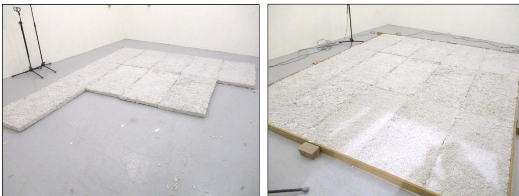
Imágenes 3 y 4 Montaje de la muestra de ensayo en la sala reverberante
