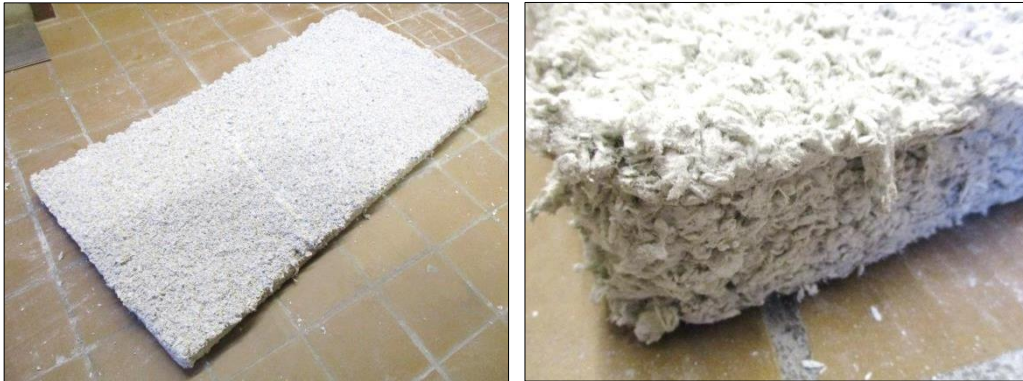
Imágenes 1 y 2 Detalles del proyectado de PERLIWOOL
