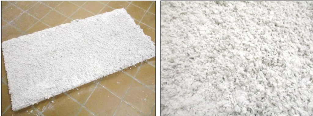
Imágenes 1 y 2 Detalles del proyectado de PERLIWOOL
