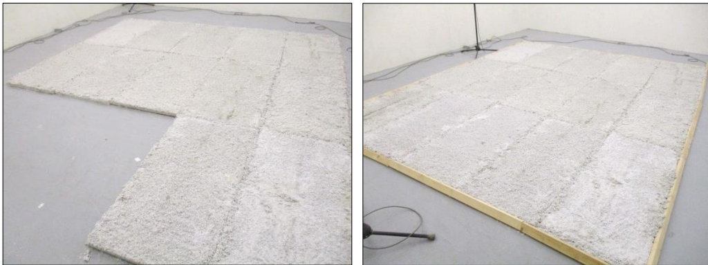
Imágenes 3 y 4 Montaje de la muestra de ensayo en la sala reverberante
