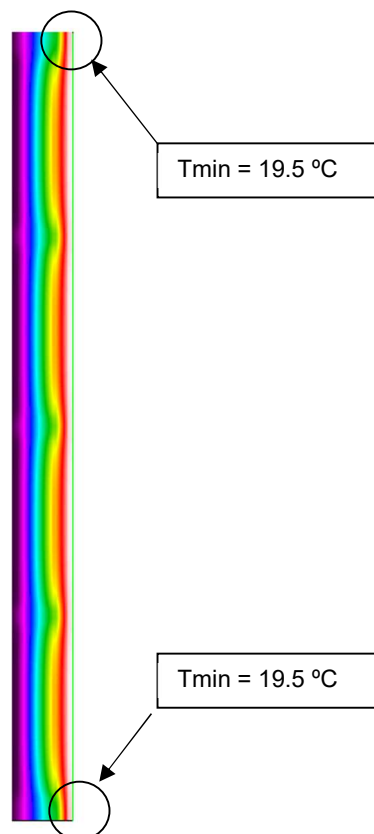
Figura 7 Temperatura mínima de la superficie interna
